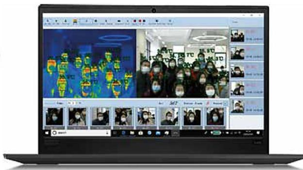
Тепловизионная система позволяет наиболее точно и быстро оценить состояние температуры тела человека путем бесконтактного измерения зоны лица или нескольких лиц одновременно на распределенной территории.
