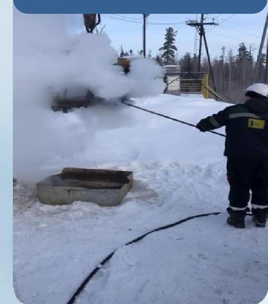
Одна из последних разработок – **автономный мобильный парогенератор ПГм-15**, имеющий привод от ДВС мощностью 18 л. с. с производительностью по **СУХОМУ ПАРУ** до 12 кг/ч. Массогабаритные характеристики позволяют перевозить его в багажнике автомобиля типа ЛАДА «Ларгус», сухая масса 72 кг.
